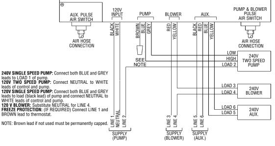
240V 2 - SPEED PUMP WITH TIMER, 240V BLOWER AND AUX. CIRCUIT.
