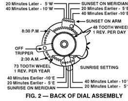
**POUR RÉGLER L'HORAIRE DU CADRAN:** tourner le cadran dans le sens antihoraire jusqu'à ce que l'heure correcte soit indiquée par l'aiguille sur la plaque signalétique. LE CADRAN DOIT TOUJOURS ÊTRE RÉGLÉ À L'HEURE NORMALE ET NON PAS À L'HEURE AVANCÉE.
